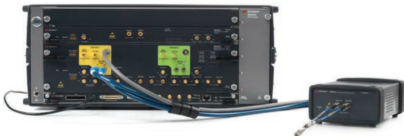
图 3. 每个通道都需要使用 M8057A 远程前端，NRZ 和 PAM-4 信号同样也需要该前端。它包含一个不含 re-timer 的可调增益放大器。用户可从用户界面选择 NRZ 或 PAM-4 编码以及去加重分接设置，而无需重新连接电缆。远程前端和模块之间的电缆长 0.85 米。这样可将远程前端安放在接近被测器件测试电路板的地方。
